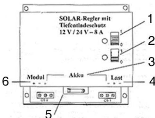
1. Diode DEL verte – accu en charge.
