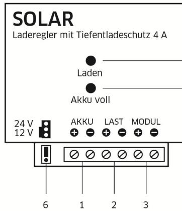
Commutateur 12/24 V sur les contacts du haut et du milieu (6) pour le fonctionnement dans les systèmes solaires photovoltaïques 24 V
