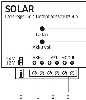
Commutateur 12/24 V sur les contacts moyens et inférieurs (6) pour le fonctionnement dans les systèmes solaires photovoltaïques 12 V
